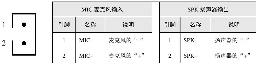
图 3.5 音频接口的引脚定义
