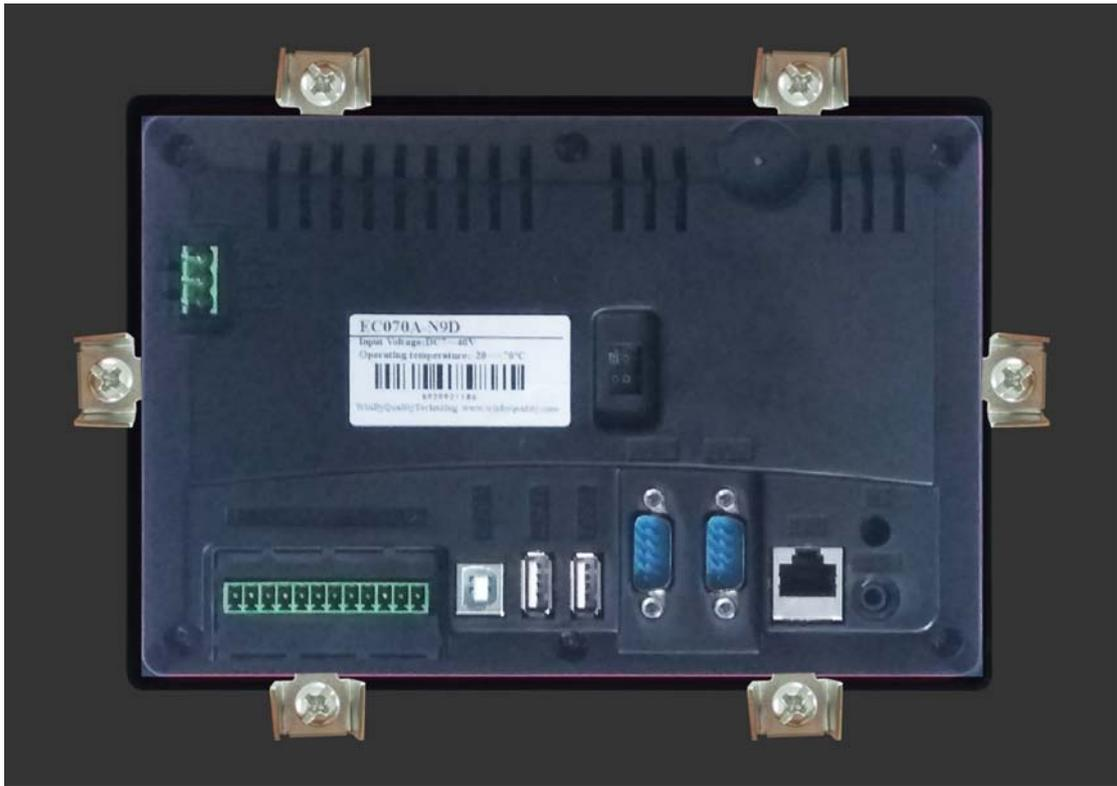
图 4.2 嵌入安装后，底面视图，一般安装左右 2 个或者上下 4 个卡扣即可
