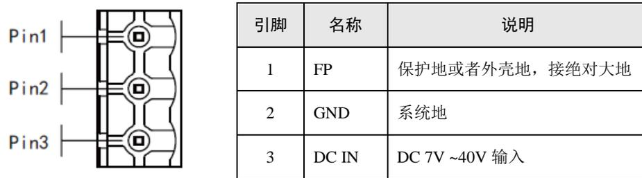
图 3.2 电源接口引脚定义
